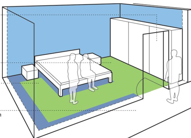
Zimmertür: Durchgangsbreite mind. 80 cm, kein unterer Türanschlag und Schwellen; Türdrücker: Gut greifbar, mit geringem Kraftaufwand zu Öffnen und zu Schließen
